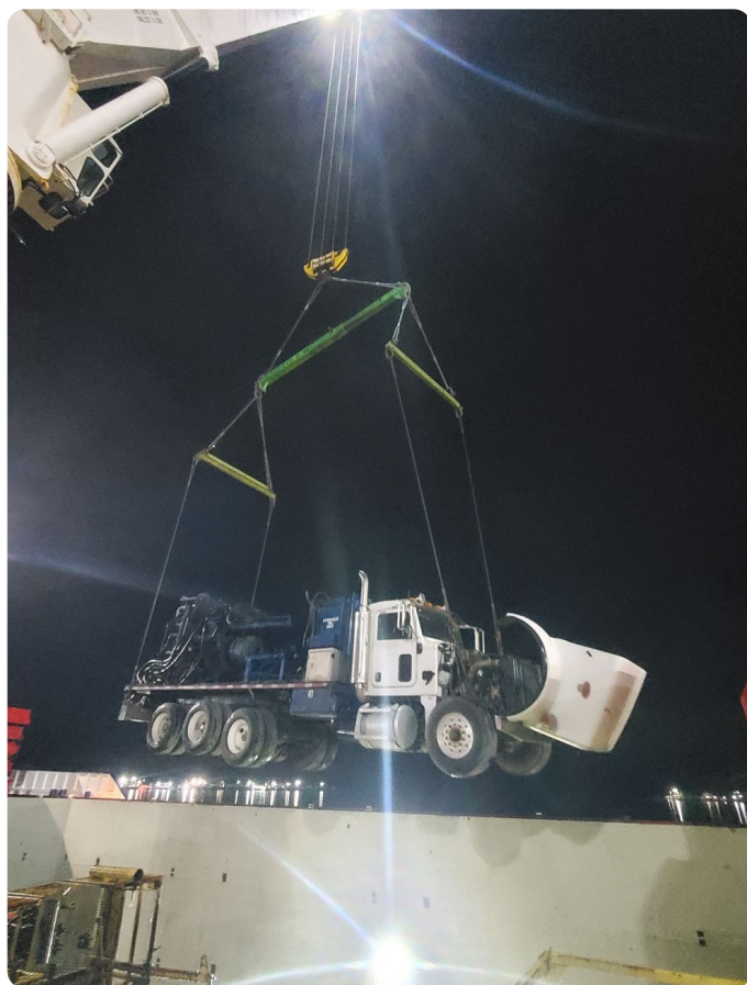
Operación nocturna: izamiento de camión con barras separadoras T&T.
